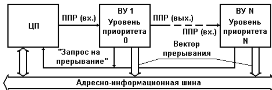
Рис. 41. Реализация приоритетов ВУ в микроЭВМ с векторной системой прерываний. С интерфейсным вектором (ППР (вх.) – "Предоставление прерывания (входной)"; "ППР (вых.) – Предоставление прерывания (выходной)")
