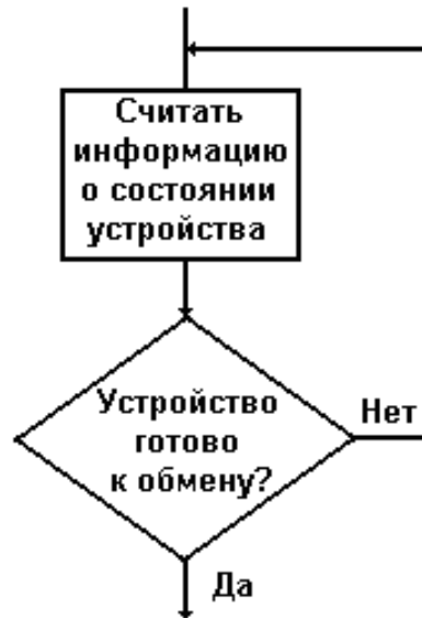
Рис. 37. Цикл программного ожидания готовности внешнего устройства
