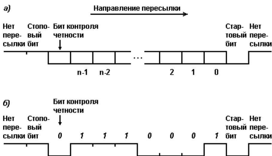
Рис. 30. Формат асинхронной последовательной передачи данных
