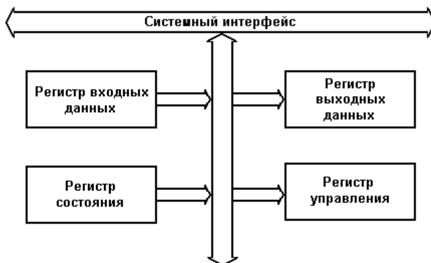
Рис. 28. Программная модель внешнего устройства
