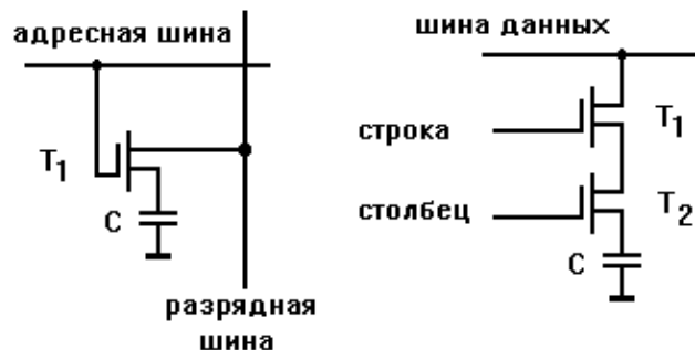
Рис. 21. Запоминающая ячейка динамического ОЗУ
