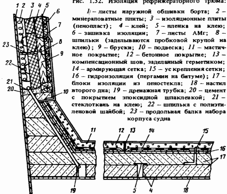
Рис. 1.32. Изоляция рефрижераторного трюма:
